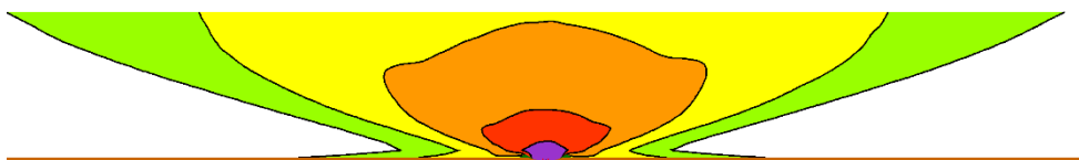
Figur 22 Vertikal støjdbredelse i udvalgt tværsnit, vej i 2 m afgravning og med 1 m høj jordvold.
